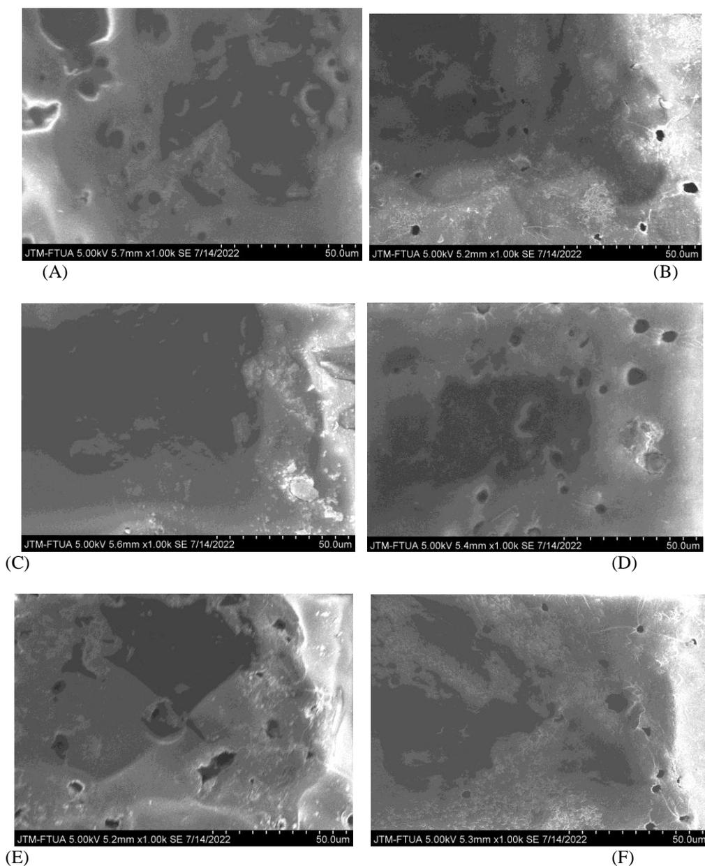
**Fig. 3. Characterization of coating polymer films: (A) PS-Starch control, (B) PS-Starch 1 (C) PS-Starch 2, (D) PS-Starch 3, (E) PS-Starch 4, (F) PS-Starch 5.**
